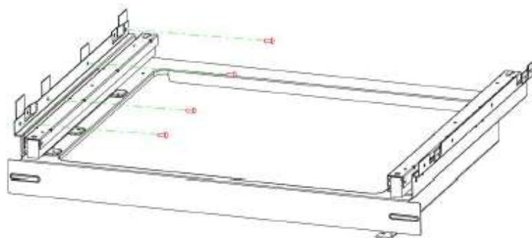
Шаг 2: Закрепите с помощью винтов. Если использовать метод установки сверху.
